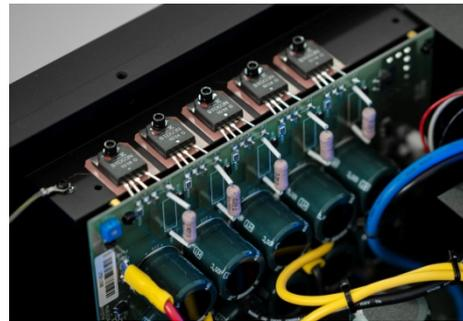
*Hier sehen Sie eine Hälfte der Transistoren eines Kanals mit den zugehörigen Siebkapazitäten, die durch die sehr nahe Positionierung ihre Kapazität blitzschnell zum Transistor liefern können.*
